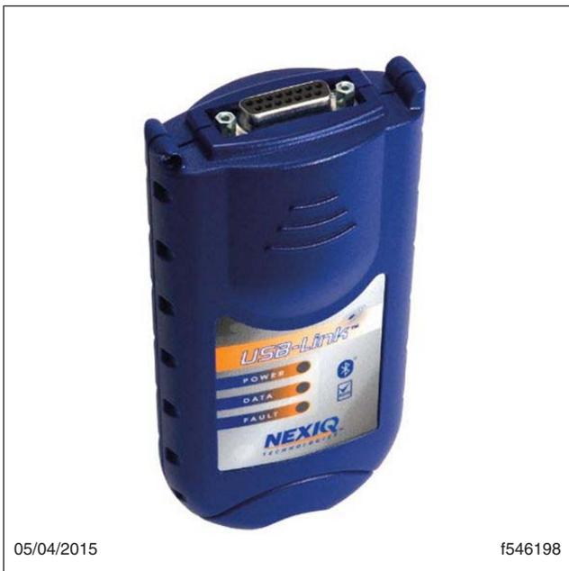
**Fig. 2, Dispositif USB-Link de première génération**
