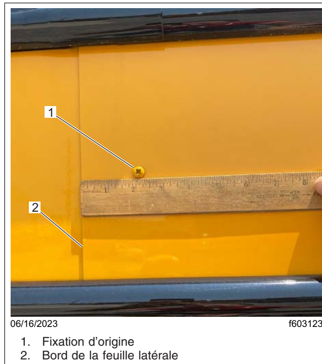
Fig. 2, Mesure de la feuille latérale par rapport à la fixation d'origine en usine
