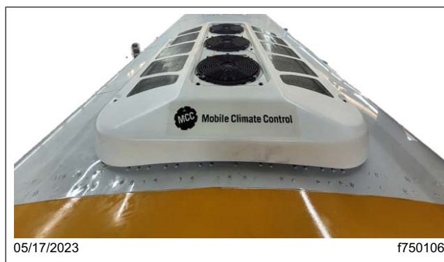
Fig. 4, Véhicule équipé d'un appareil de climatisation sur le toit installé en usine
