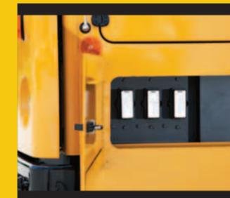
Les mécaniciens peuvent avoir accès facilement au système électrique par un panneau situé dans le bas de la structure du véhicule. Ce compartiment séparé apporte une protection accrue pour ces composantes.
